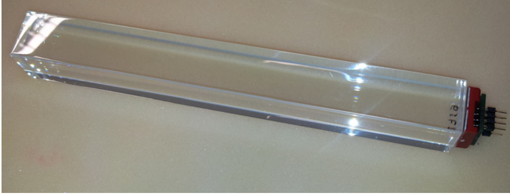
Abbildung 5: Die Grafik zeigt einen Bleiwolframat-Kristall mit angeklebten Photodioden mit der so genannten Patchpanel-Methode auf die später noch eingegangen wird. Der Kristall ist 20 cm lang und hat eine Grundfläche von 24,4 mm x 24,4 mm.
