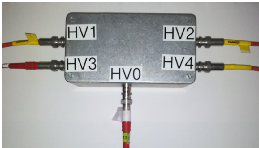
Abbildung 37: Die Grafik zeigt den für das Trigger-System angefertigten Stromteiler. Die Anschlüsse HV1 bis HV4 sind parallel verlötet. An HV0 liegt die negative Hochspannung an und wird auf die vier Kanäle verteilt. Die vier Plastik-Szintillatoren ziehen einen so geringen Strom, dass ein Ausgang (4kV/3mA) des Netzgerätes ausreicht um alle vier Szintillatoren zu betreiben.
