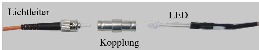
Abbildung 5.5: Bild der Verbindung zwischen Lichtleiter und LED. Die LED wurde mit Elastosil in die Kopplung geklebt. Der Lichtleiter kann an die Kopplung geschraubt werden.
