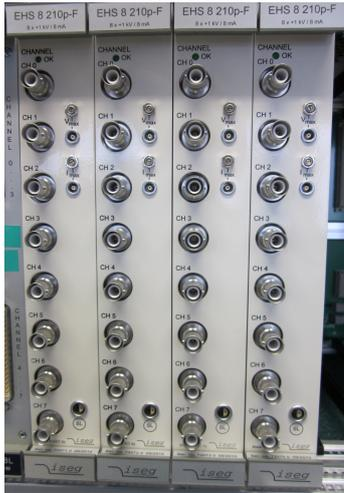
Abbildung 6.6: Die HV ISEG EHS 8 210pF . Man sieht die 4×8 Kanäle der HV. Angesteuert wird die HV mithilfe eines Computers.
