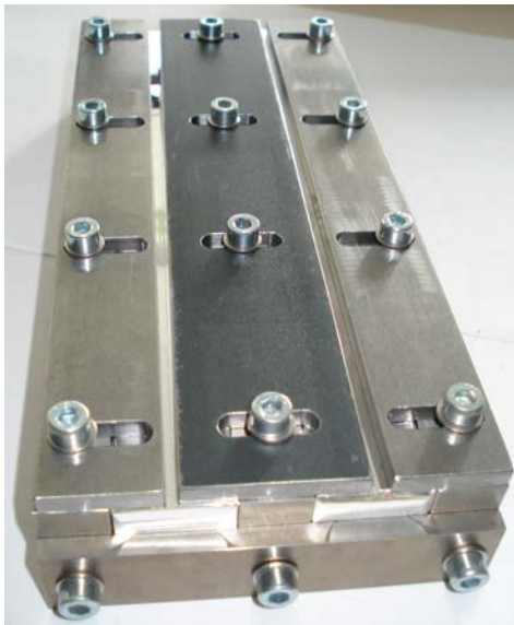
(a) Stahlform für den Folien-Formvorgang mit bereits fixierten Dummys und Reflektorfolie DF2000MA vor dem Ausheizen.
