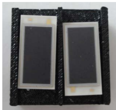
Abbildung 4.6.: Zwei Avalanche-Photodioden im erstem Modell der APD-Kapsel. In dieser Position werden APD und Kapsel auf die Kristallstirnseite geklebt, sodass sich die aktiven Flächen zentral auf der Stirnseite befinden.
