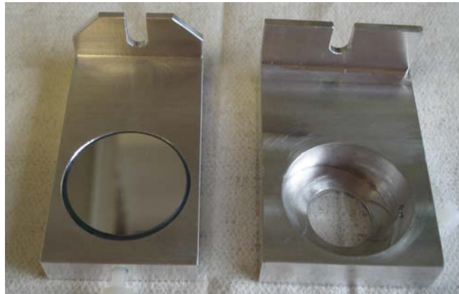
Abbildung 5.4.: links: gefertigte Spiegelhalterung mit Spiegel ThorLabs BB1-E02P2 für die Referenz-Basislinienmessung, rechts: Spiegelhalterung für die Transmissionsmessung bei 8^\circ Lichteinfall.
