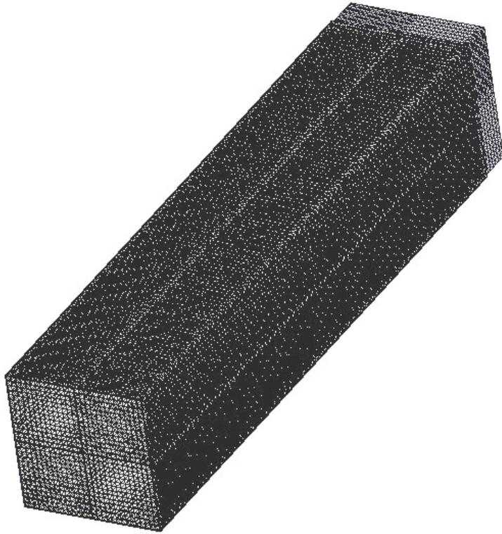
Abbildung 7.1: Vernetzung der CAD-Geometrie einer Kristalleinheit von 4 Kristallen. Je feiner die Teile einer zusammengesetzten Geometrie, desto kleiner müssen die Netzparameter gewählt werden, um eine Vernetzung vornehmen zu können.
